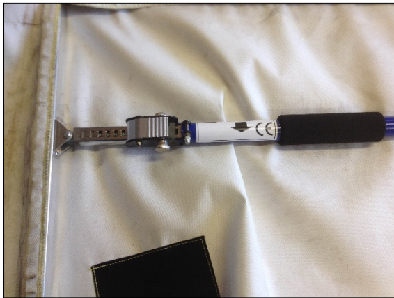
Figure 4 Gros plan sur le stoppeur de fumées. Ajusté la tige en poussant sur le bouton. Ensuite, tourner la barre dans le sens de la flèche jusqu'au maintien en place du dispositif contre les montants. (Photo: Karel Lambert)
