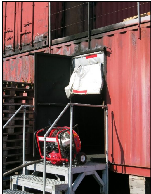
Bild 6 Der Rauchstopper verschließt den oberen Teil der Türöffnung. Dadurch wird der Rückstrom des Ventilators verringert, sodaß der Ventilator näher an die Türe herangebracht werden kann. (Picture: Michael Reick)
