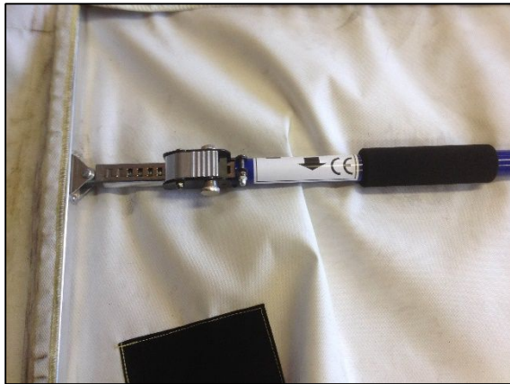
Bild 4 Nahaufnahme des Befestigungsmechanismus eines Rauchstoppers. Durch Drücken des Clips kann die Spannstange verstellt werden. Anschließend kann durch Drehen der Stange in Pfeilrichtung weiterer Druck aufgebaut werden um das ganze System unter Spannung zu setzen. (Photo: Karel Lambert)
