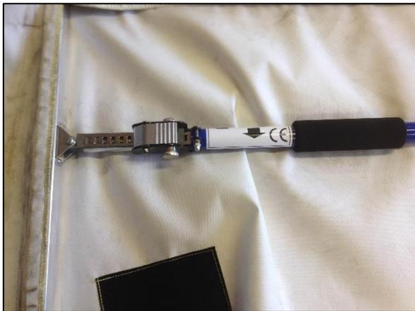
图 3 阻烟器定位装置近景图。按下夹子就可以调节杆了，随后将杆沿箭头方向转动，增加张力以在门框上固定阻烟器。
