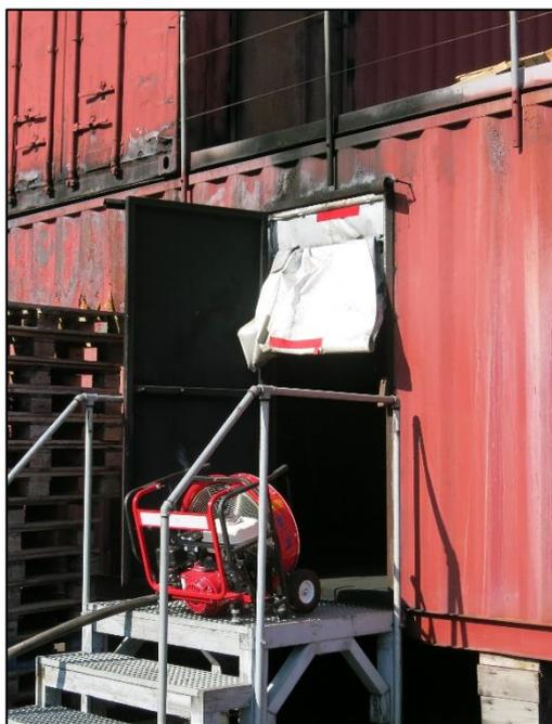
图 6 阻烟器覆盖了门的上半部分，限制了风机引起的回流，因此风机可以放置在靠近门的位置。（图片：迈克尔·赖克）
