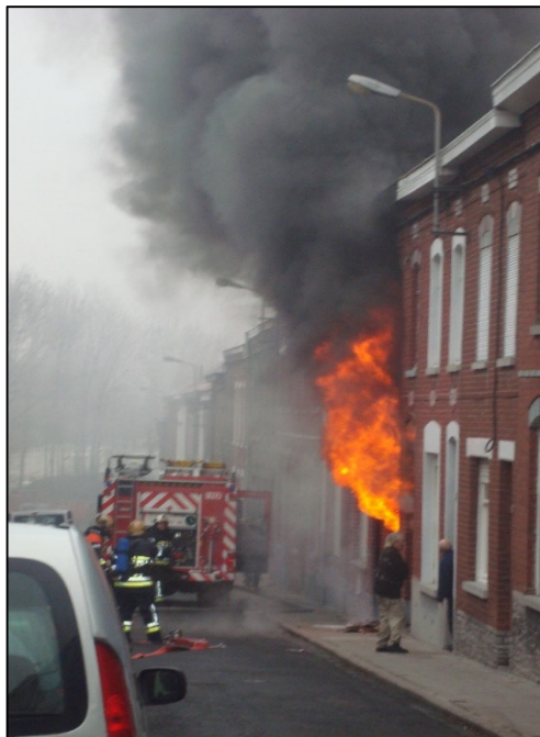
Figure 3 Un incendio completamente sviluppato in una stanza dovrebbe essere spento con meno di 500 litri di acqua. (Photo: Moeskroen Fire Department)
