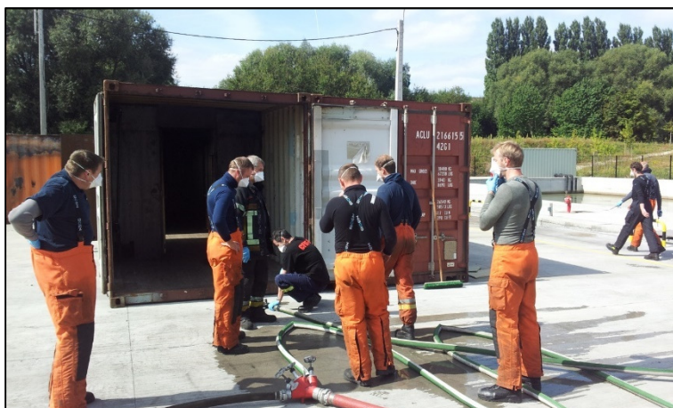
Figura 2 Preparación hecha antes de un ejercicio en el T-Cell. Dado que se están llevando trajes sucios, los participantes llevan máscara de polvo y guantes de látex. Esto particularmente se recomienda porque se están usando las lanzas sucias y bifurcaciones
