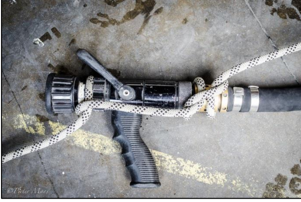
Şekil 3 Yarım kazık bağı ve tam kazık bağı, bir yüksek basınç nozulunun etrafına halat bağlamak için kullanılır. (Fotoğraf: Pieter Maes)
