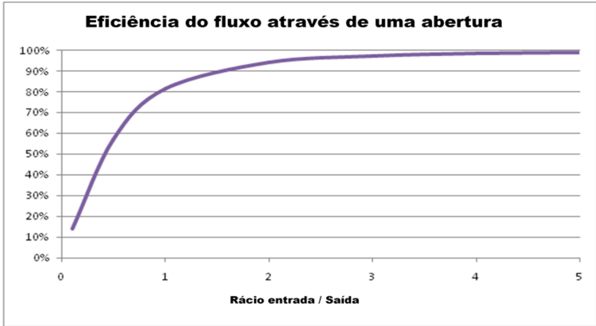
Figura 3 Eficiência do fluxo relativamente à proporção entre a entrada e saída de fumo a uma temperatura de 300°C. Quando ponto de entrada é duas vezes maior que o ponto de saída, a eficiência é de 94%. Quando a entrada tem o mesmo tamanho que a saída, esta é reduzida para 81%.
