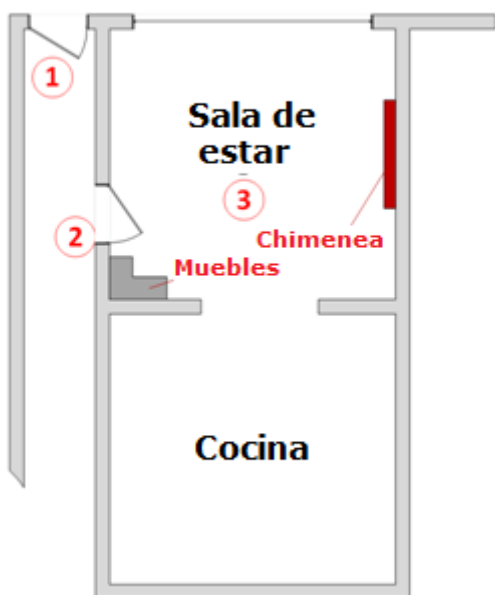
Figura 1 Esquema da disposição do piso inferior. Durante o combate ao fogo, a equipa estava a arrefecer o fumo no passeio (1). Na porta que conduz à sala de estar, foi executado um ataque massivo (2). No salão, o fogo extinguiu-se recorrendo também a técnicas de pulsações, de penciling e painting (3). (Graph: Bart Noyens)
