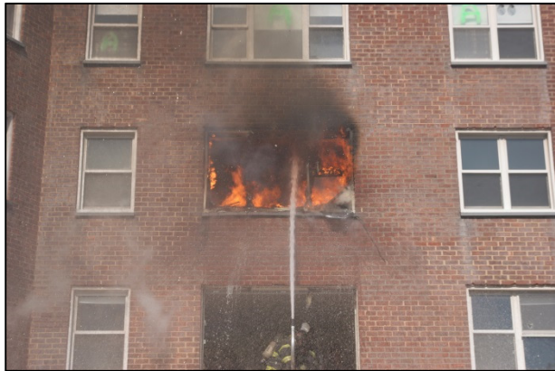
Figura 5 Utilizzo della lancia speciale per operare dal piano sotto quello dell'incendio durante una simulazione di WDF. (Photo: NIST)
