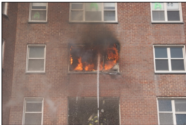
Figure 5 Utilisation de la lance d'étage inférieure pour projeter de l'eau dans l'appartement en feu pendant un feu piloté par le vent. (Photo: NIST)
