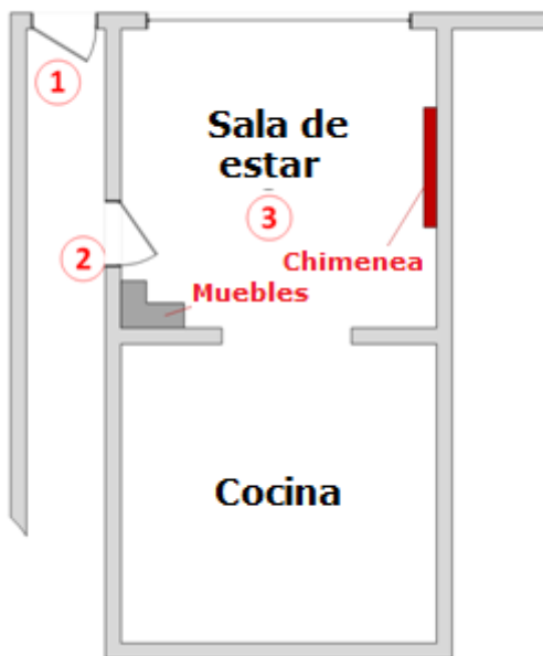
Figura 1 Esquema de la disposición de la planta baja. Durante el ataque al fuego, el quipo estaba enfriando el humo en el pasillo (1). En la puerta que conduce a la sala de estar, se ejecutó un ataque masivo (2). En el salón, el fuego se extinguió usando además técnicas de pulsaciones de penciling y pintado (3). (Graph: Bart Noyens)
