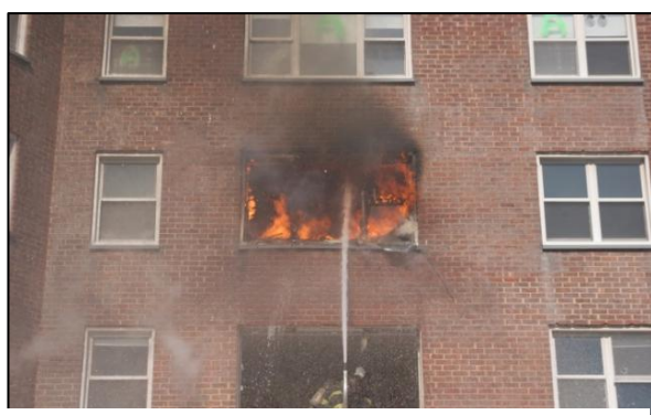
图 5 在风力驱动下，使用转角水枪将水流射入燃烧的房间。（照片：NIST）
