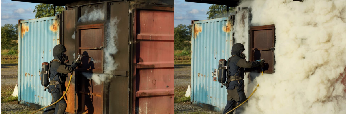
Şekil 3 Bir delik lansının backdraft öncesi durumda kullanımı. İşlenen su bir soğutma etkisi yaratır. Yüksek miktarda buhar oluşarak odayı inert hale getirir. (Fotoğraf: Lars Agerstrand)
