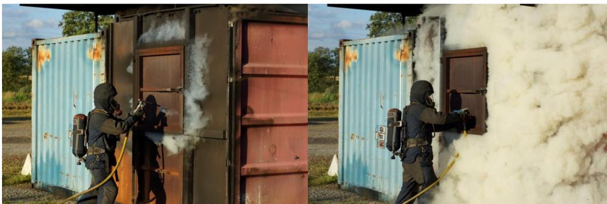
**Figura 3** Aplicação de uma agulheta perfuradora em situação de pré-backdraft. A água que flui origina um efeito de arrefecimento, formando-se também grandes quantidades de vapor que inertizam o compartimento. (Foto: Lars Ågerstrand)
