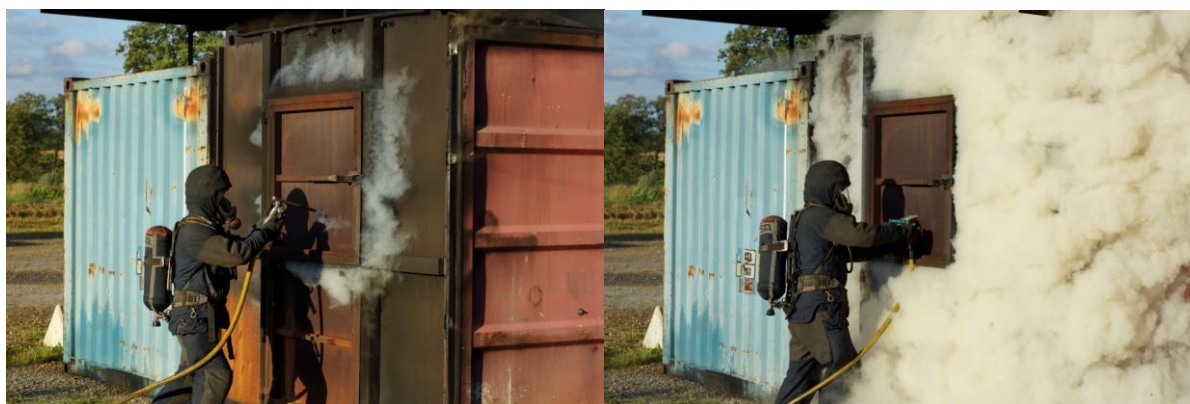
Figure 3 Applicazione della lancia piercing in una situazione di pre backdraft. L'acqua insrita all'interno creerà un'effetto di raffreddamento dei gas. Grandi quantità di vapore formerà una stanza inertizzata. (Photo: Lars Ågerstrand)
