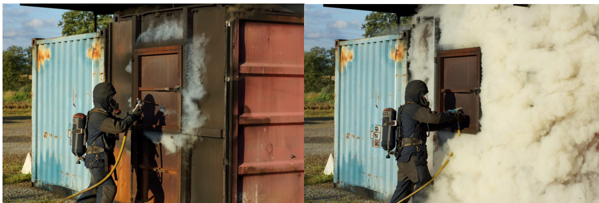
Figure 3 Utilisation d'une lance à brouillard dans une situation de pré-Backdraft. L'eau injectée va créer un effet de refroidissement. Une grande quantité de vapeur est formée ce qui inerte la pièce. (Photo: Lars Ågerstrand)
