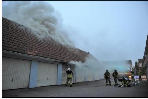
图2 “在通风受限型火场中使用眼镜蛇水枪（照片：帕特里克·佩尔森，©瑞典水切割系统公司 2012）
