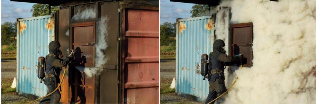
图 3 在将发生回燃的情况下使用穿刺水枪，射入的水产生冷却效果，形成大量蒸汽，惰化房间。
