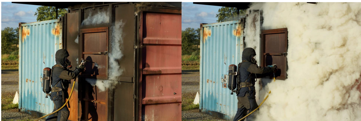
Figuur 3 Toepassing van een piercing nozzle op een pre-backdraft situatie. Het water dat naar binnen gespoten wordt, zorgt voor afkoeling. Er worden grote hoeveelheden stoom geproduceerd die de ruimte inertiseren. (Foto: Lars Ågerstrand)
