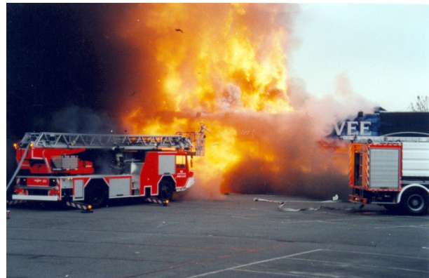
Figuur 7 Nadat een brandweerman een opening gemaakt heeft in een ruit treedt een heel heftige hot backdraft op. (Foto: Benoît Amans)
