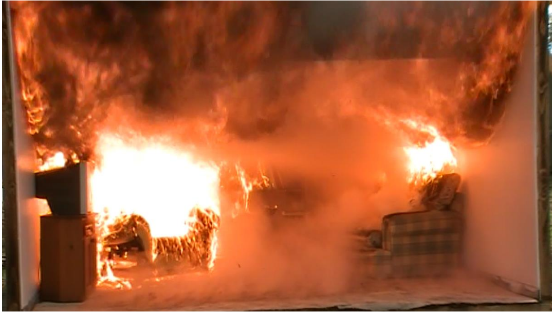
Figure 4.3 Avviene il Flashover. L'intera stanza è avvolta dalle fiamme. I pirolizzati rilasciati dal divano sono chiaramente visibili. La moquette sul pavimento sta pirolizzando. (Photo: New South Wales Fire & Rescue Service)
