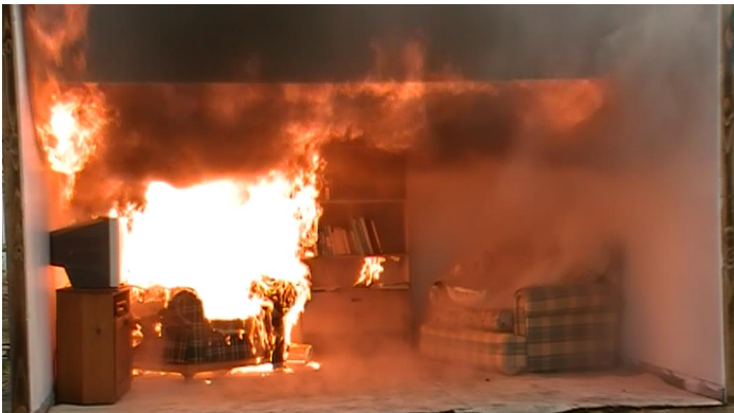
Figure 4.2 Il fuoco si sta sviluppando. Lo strato di fumo si accende. I pirolizzati sono chiaramente visibili vicino alla poltrona di destra a causa del calore radiante. La libreria mostra anche segni di incendio propagato nella parte inferiore. (Photo: New South Wales Fire & Rescue Service)
