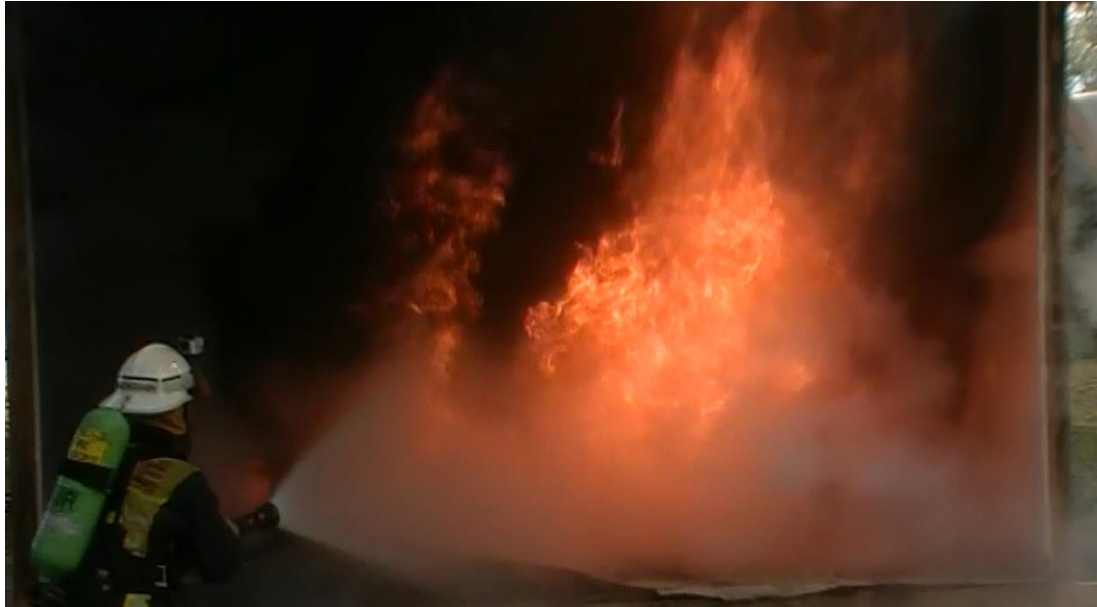
Figure 4.5 L'operatore alla lancia avvia l'estinzione con un attacco massiccio. Al momento della fotografia ha completato i 3/4 di un cerchio. Ha iniziato nell'angolo in alto a destra e ha raggiunto il centro in basso. L'effetto di soppressione si ottiene principalmente producendo vapore. La differenza con la figura 4.4 è immensa. (Photo: New South Wales Fire & Rescue Service)
