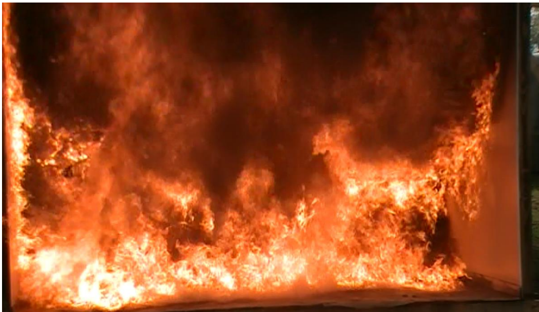
Figure 4.4 L'incendio ha ora raggiunto il pieno sviluppo. La potenza del fuoco è estremamente alta per una stanza del genere perché non c'è una parete frontale. Ciò significa che è disponibile molto più ossigeno per l'incendio rispetto a un incendio interno "reale". (Photo: New South Wales Fire & Rescue Service)
