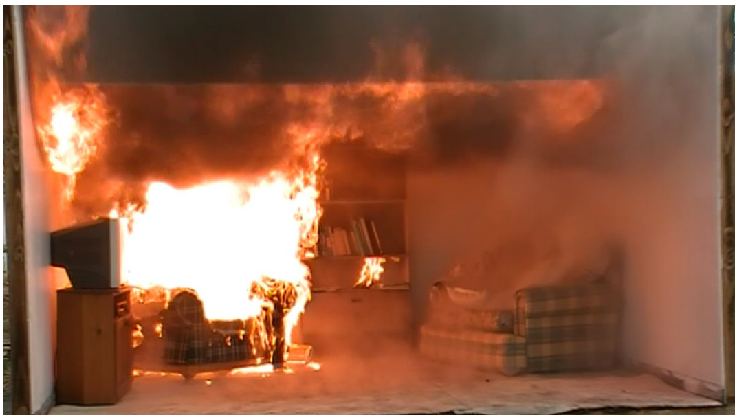
Bild 4.2 Das Feuer breitet sich aus und die Rauchsicht entzündet sich. Über dem rechten Sessel sieht man deutlich, die, durch die Strahlungswärme freigesetzten, Pyrolysegase. Auch auf den Bücherschrank hat bereits ein Brandübergriff stattgefunden. (Foto: New South Wales Fire & Rescue Service)
