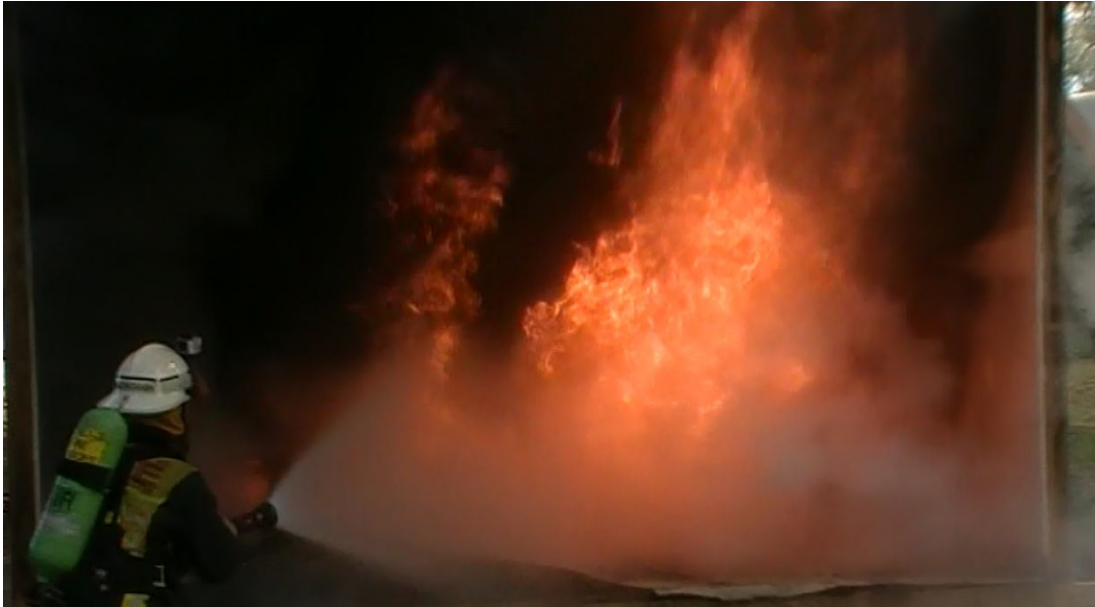
Bild 4.5 Der Strahlrohrführer beginnt den Löschvorgang mit einem massiven Angriff. Zu dem Zeitpunkt, als das Bild gemacht wurde hat er bereits einen 3/4 tel Kreis ausgeführt. Er ist oben rechts begonnen und ist jetzt unten in der Mitte angekommen. Der Löscheffekt wird hauptsächlich durch den erzeugten Dampf erreicht. Der Unterschied zu Bild 4.4 ist schon jetzt enorm. (Foto: New South Wales Fire & Rescue Service)
