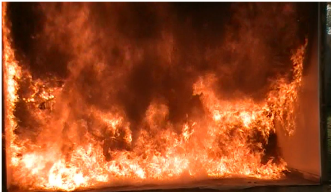
Bild 4.4 Der Brand ist jetzt vollentwickelt. Die Brandleistung steigt außerordentlich hoch an, weil die vordere Wand komplett fehlt. Dadurch kann viel mehr Sauerstoff einströmen, als bei einem „echten“ Brand. (Foto: New South Wales Fire & Rescue Service)
