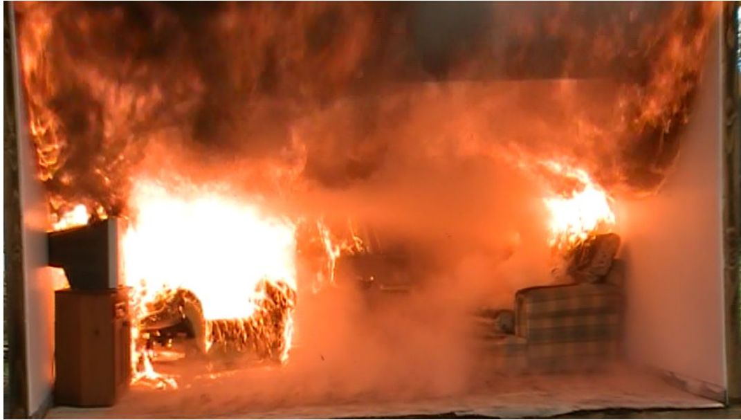
Bild 4.3 Der Flashover tritt ein und es kommt zur Raumdurchzündung. Die Pyrolysegase aus dem Sessel rechts im Bild, sind deutlich sichtbar. Auch der Teppich auf dem Boden pyrolysiert bereits sehr stark. (Foto: New South Wales Fire & Rescue Service)
