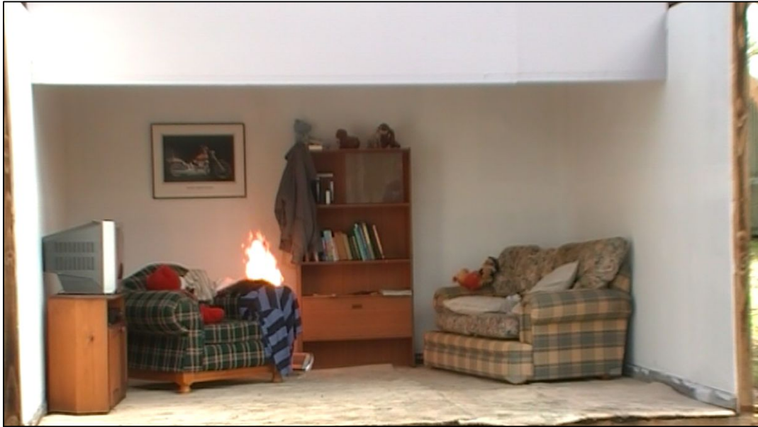
Bild 4.1 In dem Modellnachbau eines Livings wird ein Brand gelegt. (Foto: New South Wales Fire & Rescue Service)
