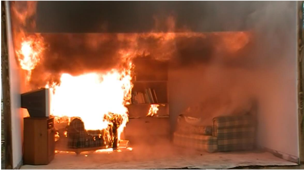
图 4.2 火灾发展阶段。烟气层被点燃，由于火源热辐射，热解物在靠近右侧沙发处清晰可见。书架底部也显示出火势蔓延的迹象。（照片：新南威尔士州消防和救援服务）
