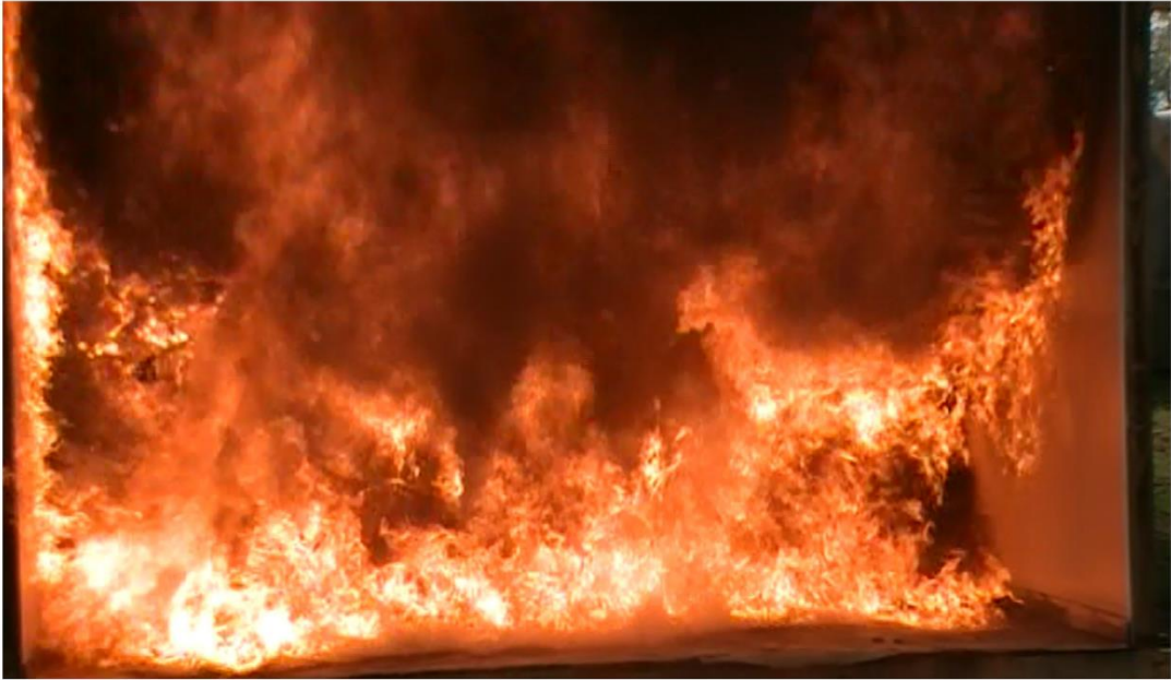
图 4.4 火灾达到全面发展阶段。由于室内没有前墙，火焰相对房间来说就非常高。这表明火灾测试要比真正室内火灾需要更多氧气供应。（照片：新南威尔士州消防和救援服务）
