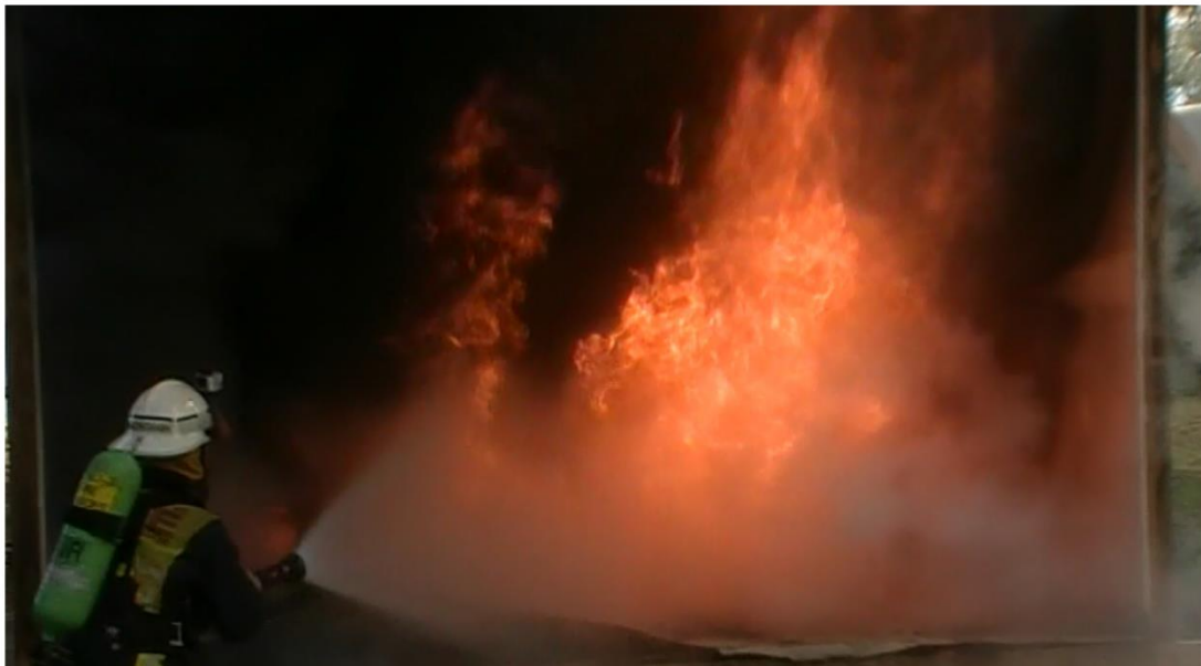
图 4.5 消防员开始实施灭火工作。抑制效果主要是通过雾化蒸汽实现，与图 4.4 有所区别。（照片：新南威尔士州消防和救援服务）
