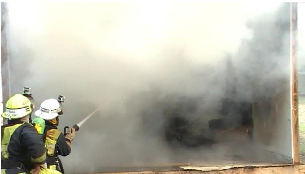
图 4.6 火焰熄灭后，消防员切换至直流射水模式，采用较低水流量对燃料表面进一步冷却防止可燃物复燃。（照片：新南威尔士州消防和救援服务）
