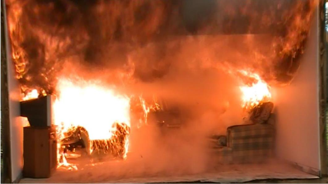
图 4.3 发生轰燃。整个房间内充满火焰，右侧沙发的热解产物清晰可见，地板上的地毯也在热解。（照片：新南威尔士州消防救援局）
