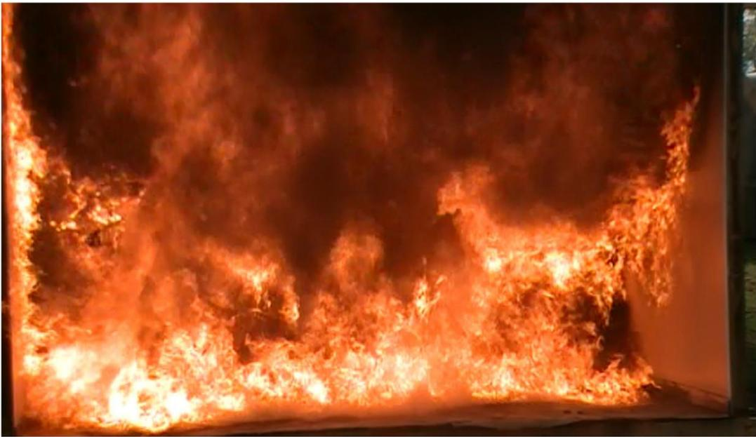
图 4.4 火灾已达到猛烈燃烧阶段。由于房间前面没有墙，火焰能量非常大。这表明比真正室内火灾有更多氧气供应。（照片：新南威尔士州消防救援局）
