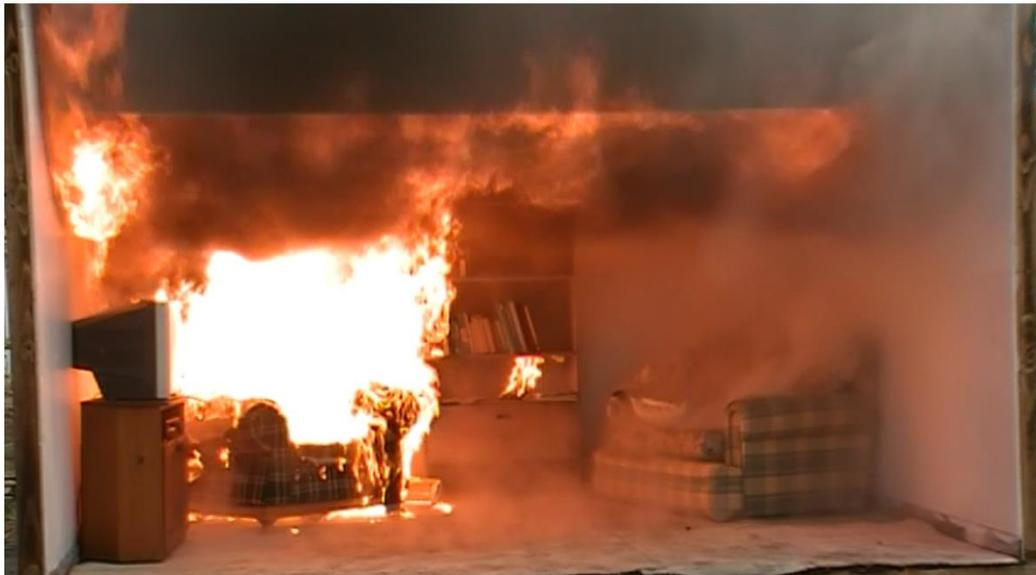
图 4.2 火灾发展阶段，烟气层被点燃，由于热辐射，在右侧沙发处热解物清晰可见。书架底部也有火势蔓延的迹象。（照片：新南威尔士州消防救援局）
