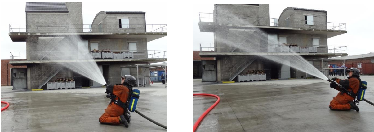
Figure 1.3 & 1.4 A sinistra è mostrato un impulse corto. . L'angolo della Lancia rispetto al livello del suolo è di 45°. L'angolo del cono dell'acqua varia da 40° a 60°. La fotografia a destra mostra un impulse lungo. L'angolo tra la Lancia e il livello del suolo è di circa 30° e anche l'angolo del cono è di 30°. (Foto: Geert Vandamme)
