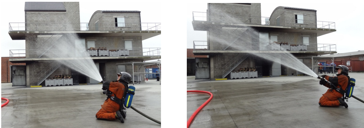
Figure 1.3 & 1.4 L'image de gauche montre une impulsion courte (short pulse). L'angle de la lance par rapport au sol est de 45°. L'angle de distribution du spray d'eau est compris entre 40° et 60°. La photo de droite montre une impulsion longue (long pulse). L'angle entre la lance et le niveau du sol est d'environ 30 ° et l'angle du cône de distribution est également de 30 °. (Photos: Geert Vandamme)
