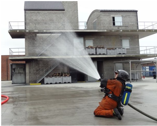
Bild 1.3 & 1.4 Auf dem linken Bild wird ein ‚short pulse‘ abgegeben. Der Winkel zwischen Strahlrohr und Boden beträgt etwa 45°. Der Öffnungswinkel des Sprühkegels beträgt 40 – 60°. Auf dem rechten Foto wird ein ‚long pulse‘ abgegeben. Der Winkel zwischen Strahlrohr und Boden beträgt hier etwa 30°. Der Öffnungswinkel des Sprühkegels ist auf 30° eingestellt. (Fotos: Geert Vandamme)
