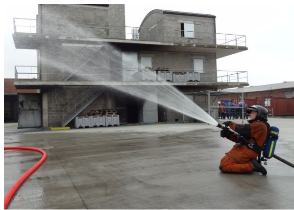
Bild 1.3 & 1.4 Auf dem linken Bild wird ein ‚short pulse‘ abgegeben. Der Winkel zwischen Strahlrohr und Boden beträgt etwa 45°. Der Öffnungswinkel des Sprühkegels beträgt 40 – 60°. Auf dem rechten Foto wird ein ‚long pulse‘ abgegeben. Der Winkel zwischen Strahlrohr und Boden beträgt hier etwa 30°. Der Öffnungswinkel des Sprühkegels ist auf 30° eingestellt. (Fotos: Geert Vandamme)
