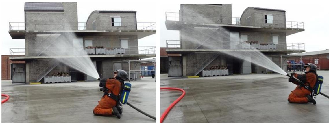
图 1.3 & 1.4 左图为短脉冲射水，水枪与地面夹角为  $45^{\circ}$ ，雾化角在  $40^{\circ}$  到  $60^{\circ}$  之间。右图为长脉冲射水。水枪与地面夹角约为  $30^{\circ}$ ，雾化角也为  $30^{\circ}$ 。(图片来源:Geert Vandamme)
