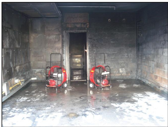
Fig. 9.11 Configuração em forma de V numa sala onde as paredes laterais estão muito próximas umas das outras e os ventiladores não conseguem aspirar ar suficiente (Foto: Karel Lambert)
