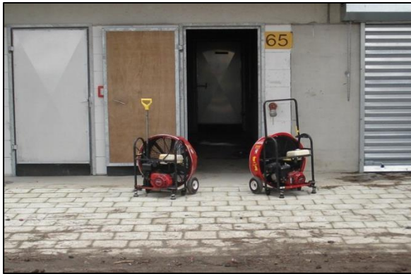
Fig. 9.10 Dois ventiladores configurados em V num ângulo de 20° (Foto: Karel Lambert)
