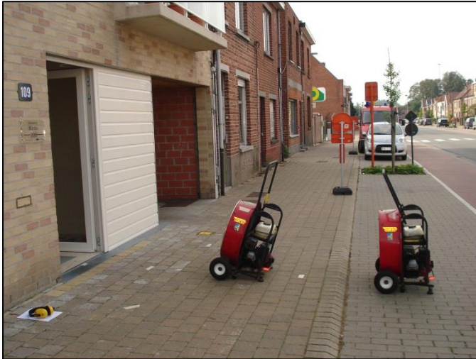
Fig. 9.5 Configuração de dois ventiladores um atrás do outro durante as experiências em Oostkamp (Foto: Karel Lambert)
