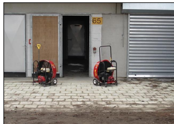
Fig. 9.9 Dois ventiladores em configuração em V. O ângulo é de 30° (Foto: Karel Lambert)
