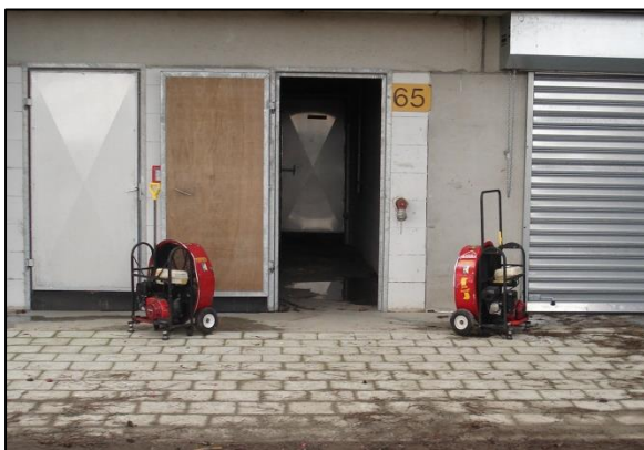
Fig. 9.8 Dois ventiladores em forma de V. O ângulo é de 45° (Foto: Karel Lambert)
