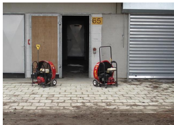
Fig. 9.9 Due ventilatori in formazione a V. Angolo di 30° (Foto: Karel Lambert)
