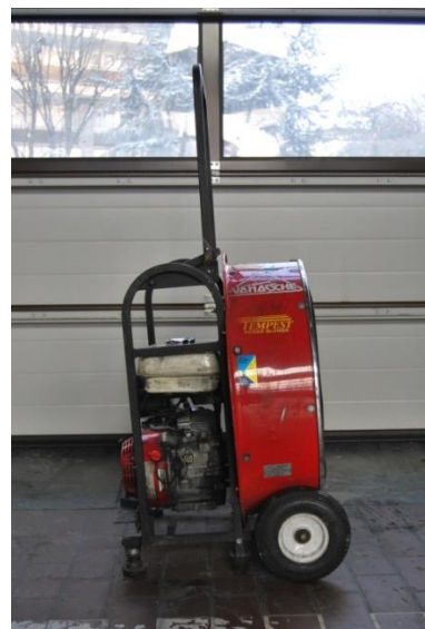
Fig. 9.1 Ventilatore convenzionale (Foto: German Berckmans)
