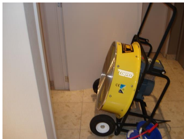
Figs. 9.12 & 9.13 Nei test in Oostkamp due ventilatori sono stati posizionati a forma di V all'entrata della porta di un edificio di appartamenti. Un terzo ventilatore è stato aggiunto in fondo alla scala. (Foto: Karel Lambert)
