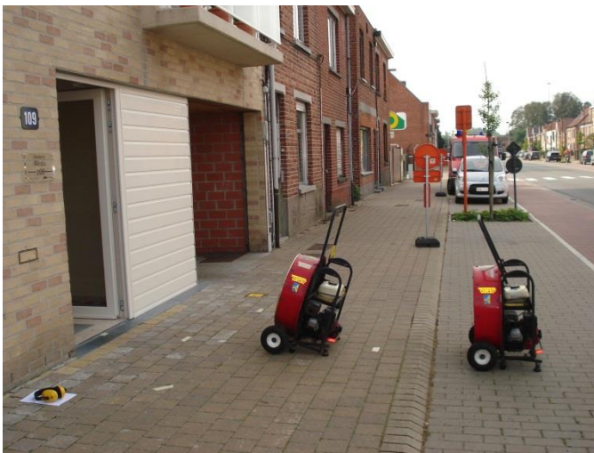
Fig. 9.5 Configurazione di due ventilatori uno dietro l'altro durante l'esperimento a Oostkamp (Foto: Karel Lambert)
