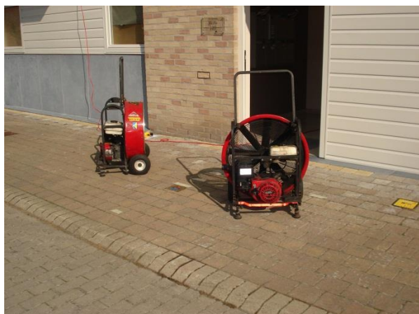
Figs. 9.12 & 9.13 Nei test in Oostkamp due ventilatori sono stati posizionati a forma di V all'entrata della porta di un edificio di appartamenti. Un terzo ventilatore è stato aggiunto in fondo alla scala. (Foto: Karel Lambert)
