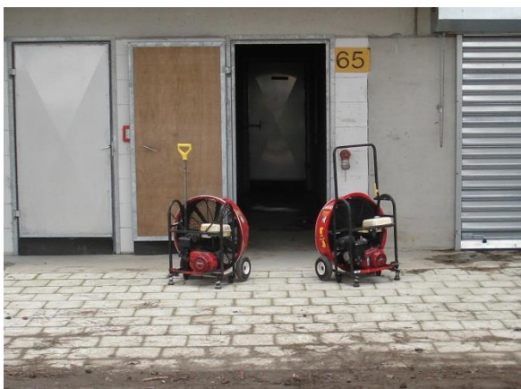
Fig. 9.10 Due ventilator in formazione a V. Angolo di 20° (Foto: Karel Lambert)
