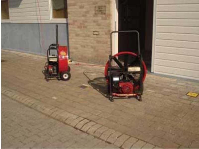
图 4 在 Oostkamp 的测试中，两台风机在一栋公寓房入口处以“V”字型摆放。
