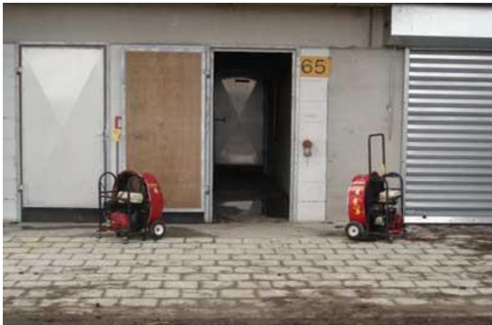
图 1 两个风机成 45° “V” 字型摆放。(本文作者供图)
