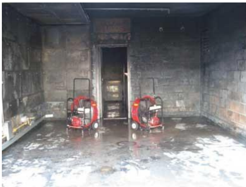
图 3 房间内侧墙距离过近，“V”字型摆放的风机无法抽取足够的空气。(作者供图)
