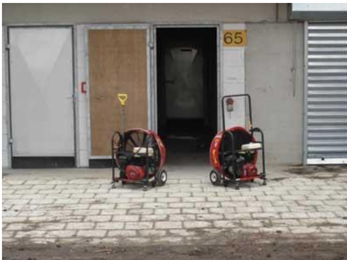
图 2 两个风机成 20° “V” 字型摆放消防员无论进出都不方便（本文作者供图）
