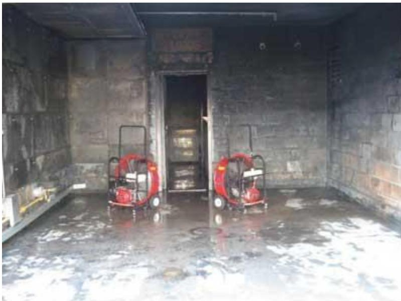
照片 3 房间内侧墙距离过近，“V”型摆放的排烟机无法吸入足够的空气。(作者供图)
