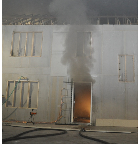
Şekil 2.1 Duman gazı kapının üst kısmından çıkarken, boşluğun diğer kısmı içeri giren taze hava tarafından kullanılmaktadır. Bu taze hava yangının hızla büyümesini sağlar. (Foto: Steve Kerber – Underwriters Laboratories)
