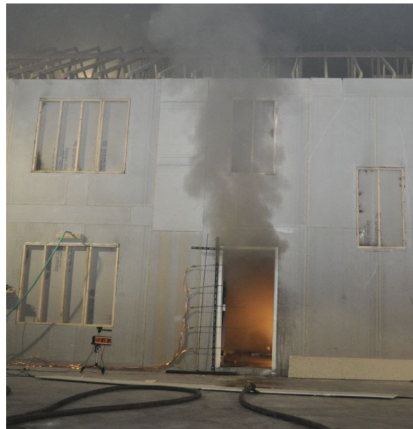
Bild 2.1 Die Rauchgase strömen durch den oberen Teil der Türöffnung aus, während der Rest der Türe zur Luftzufuhr genutzt wird. Die große Menge Frischluft wird dafür sorgen, dass der Brand sich sehr schnell ausbreitet. (Foto: Steve Kerber – Underwriters Laboratories)
