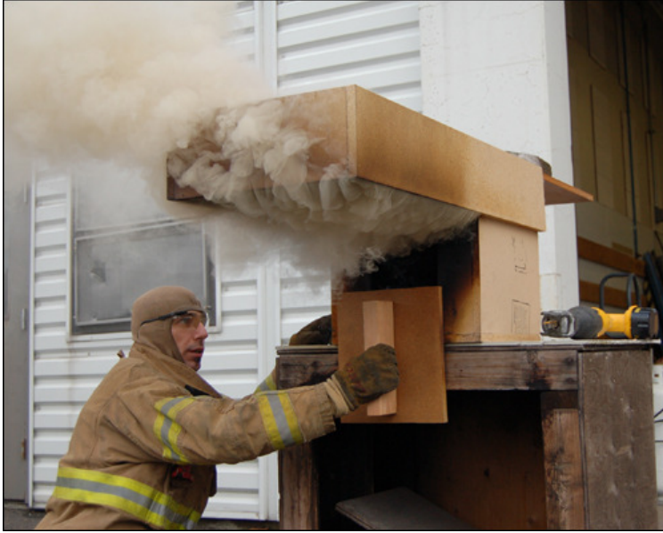
Şekil 1.1 Arka taraftaki oda yanmaktadır. Yangın gazı kapalı kapıdan sızmıştır ve tavanın altında patlayıcı bir karışım oluşturmuştur. (Fotoğraf: Ed Hartin)
