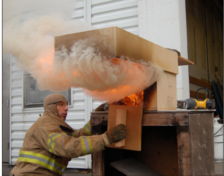
Şekil. 1.2 Kapıyı açmak alevlerin odayı terk etmesine ve karışımı tutuşturmasına neden olur. (Fotoğraf: Ed Hartin)
