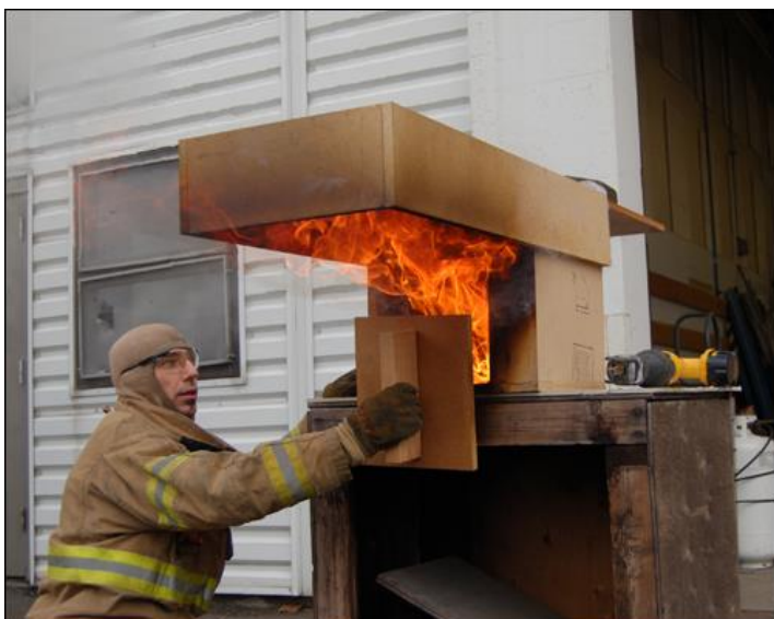
Fig 1.3 Incendio pienamente sviluppato dopo un Flash Fire. (Photo: Ed Hartin)
