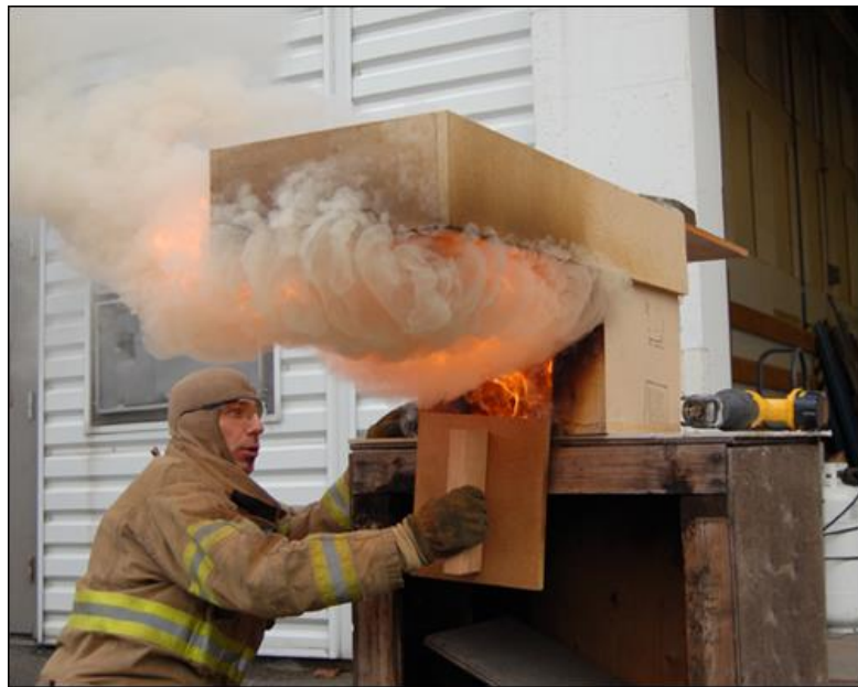
Fig. 1.2 L'apertura della porta consentirà alle fiamme di uscire e accendere la miscela. (Photo: Ed Hartin)
