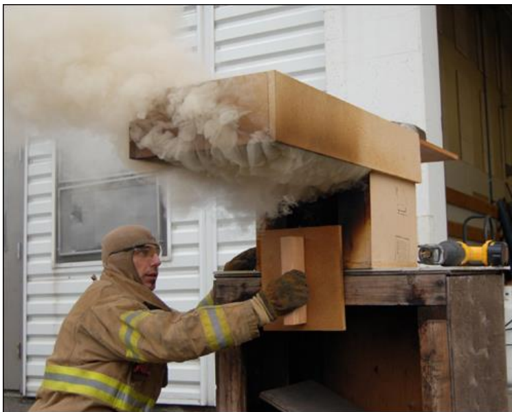
Fig 1.1 Lo scomparto sul retro sta bruciando. I fumi sono fuoriusciti dalla porta chiusa e hanno formato una miscela esplosiva contro il soffitto. (Photo: Ed Hartin)
