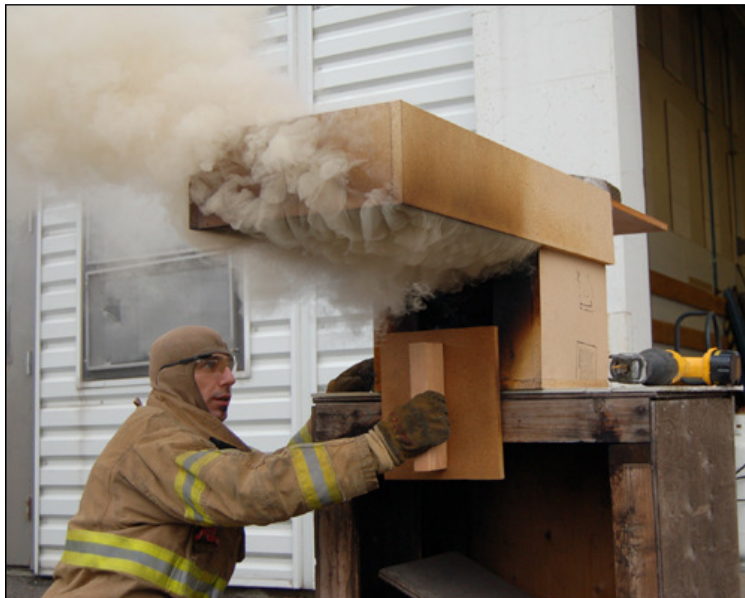
Fig. 1.1 La parte trasera del compartimento está ardiendo. El humo que ha salido a través de la puerta cerrada ha formado una mezcla explosiva contra el techo. (Photo: Ed Martin)
