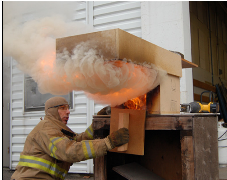
Fig. 1.2 El abrir la puerta, permitirá que las llamas salgan e inflamen la mezcla. (Photo: Ed Hartin)
