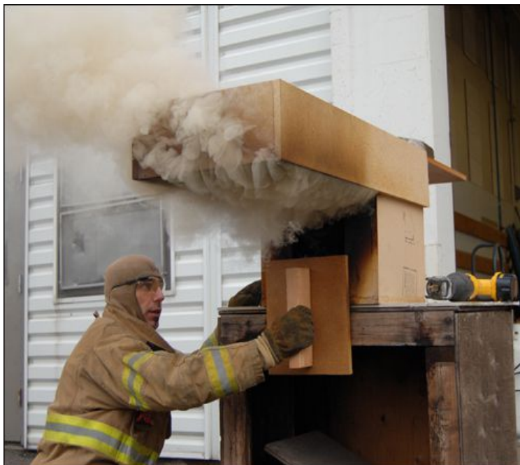
Bild 1 Der hintere Raum brennt, Rauchgase sind durch die geschlossene Türöffnung geströmt und bilden ein explosives Gemisch unter der Zimmerdecke (Foto: Ed Hartin)
