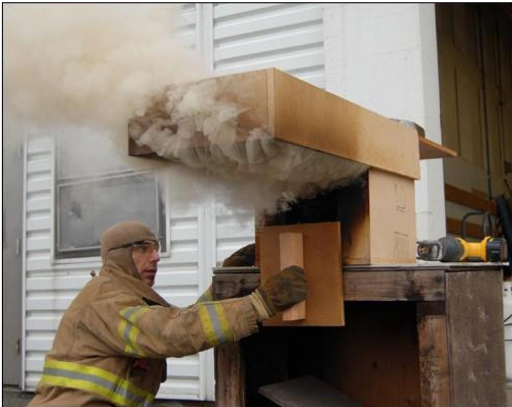
图 1.1 后面的隔间正在燃烧。烟气从门缝钻出，并在天花板处并形成了可燃的气体混合物（照片：Ed Hartin）
