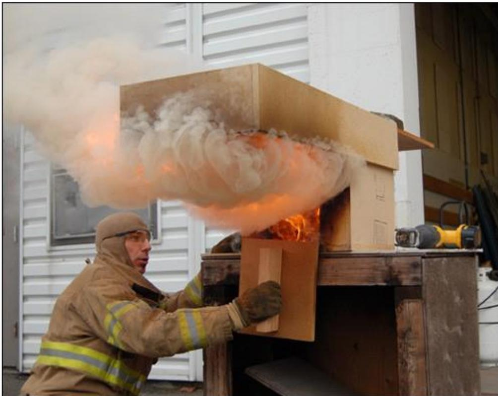
图 1.2 开门会使火焰窜出并点燃混合物
