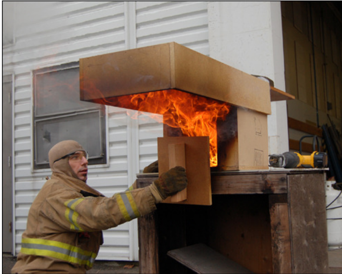
Fig 1.3 Volontwikkelde brand na optreden van Flashfire. (Foto: Ed Hartin)
