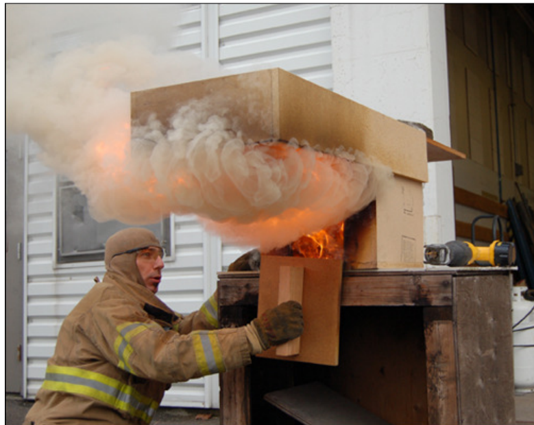
Fig. 1.2 Het openen van de deur maakt dat vlammen naar buiten slaan en het mengsel ontsteken. (Foto: Ed Hartin)
