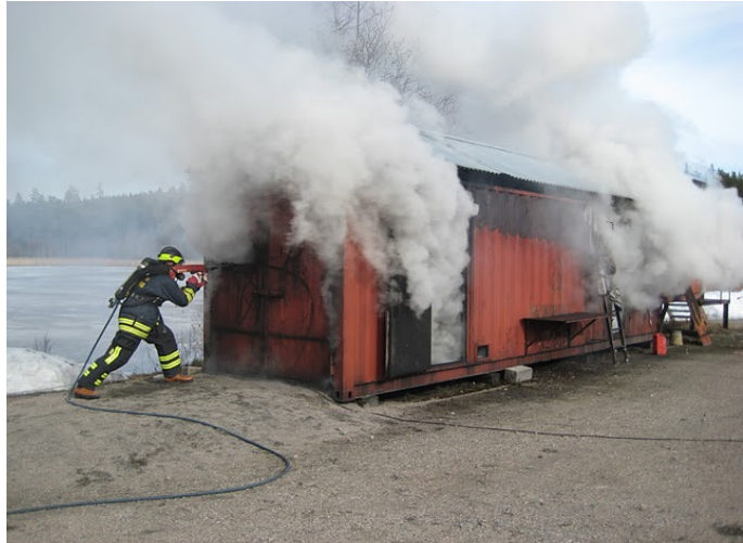
Şekil 12.4 Bir eğitim sahasında kullanılan Cobra. Yangın gazları tamamen soğutuldu ve inert hale geldi. (Fotoğraf: Willem Nater)
