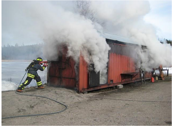
Fig 12.4 La Lancia Cobra in azione in un addestramento. I gas di combustione sono completamente inerte e raffreddati. (Picture by: Willem Nater)
