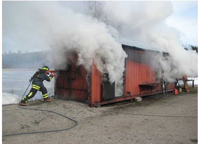
Bild 4 Der 'cobra' in Aktion an einem Übungsobjekt. Die Rauchgase werden völlig inertisiert und darüber hinaus stark abgekühlt (Foto: Willem Nater)
