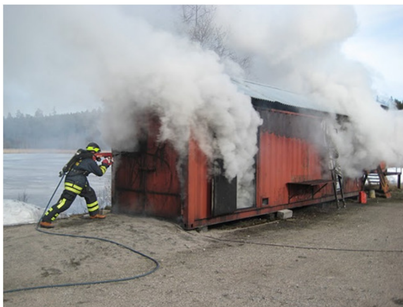
Fig. 12.4 la lanza Cobra en acción en un lugar de prácticas. Los gases del incendio se vuelven completamente inertes y son enfriados.
