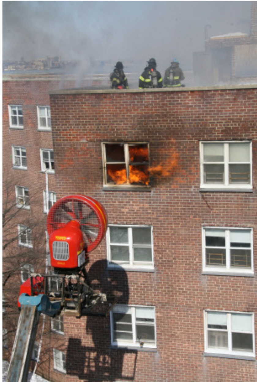
Fig 9.1 Evacuation asymétrique des gaz de combustion ( Photo : Scott Stilborn – OFS Photographer )
