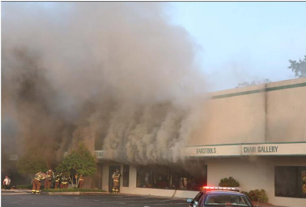
图 5.3 烟气开始从破开的外窗排出，同时大量新鲜空气进入火场
