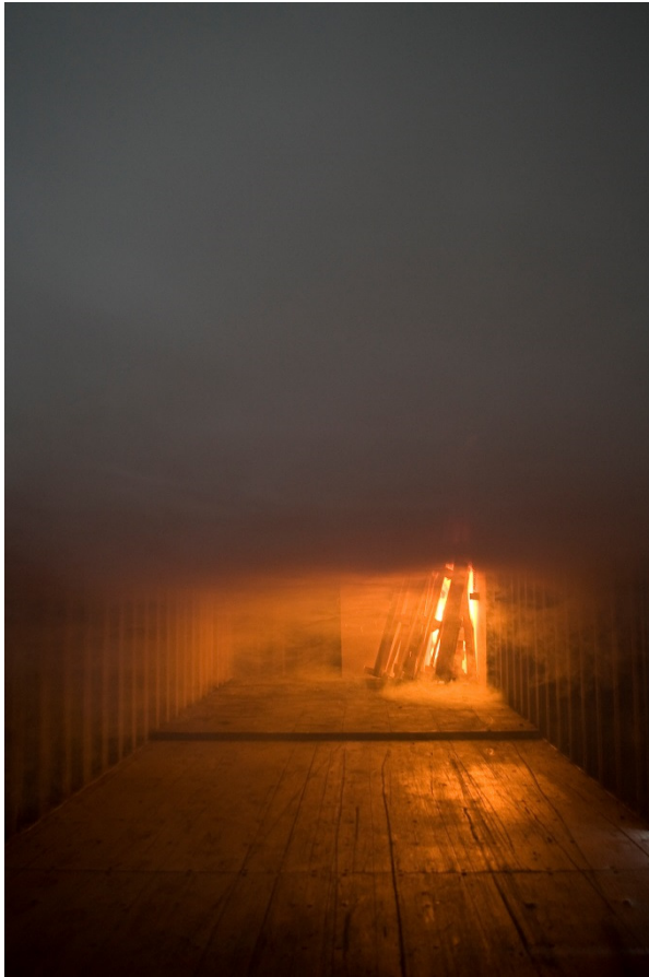
Figura 2 Establecimiento de la zona neutral en una celda de ataque. Por encima encontramos el humo gris oscuro. Debajo todavía hay una buena visibilidad. (Imagen :Stef Vandersmissen - Departamento de Incendio de Zaventem)
