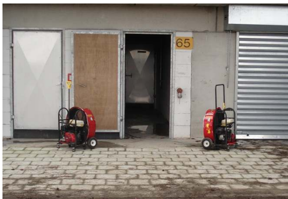
Fig 9.8 Deux ventilateurs en V. L'angle entre les ventilateurs est de 45° (Photo: Karel Lambert).
