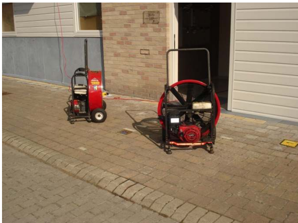
Fig 9.12 & fig 9.13 Lors des essais menés à Oostkamp, deux ventilateurs ont été positionnés en V au niveau de la porte d'entrée d'un immeuble à appartements. Ce dispositif est complété par un troisième ventilateur placé au pied de la cage d'escaliers (Photos: Karel Lambert).
