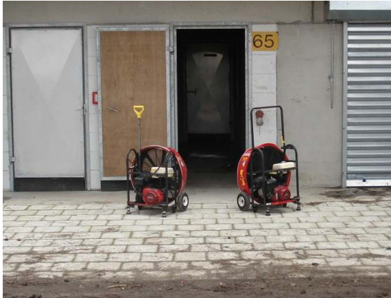
Fig 9.10 Deux ventilateurs en V. L'angle entre les ventilateurs est de 20° (Photo: Karel Lambert).
