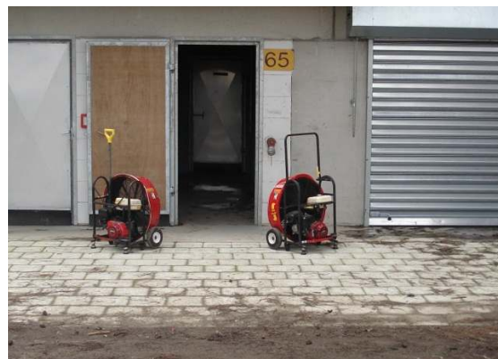
Fig 9.9 Deux ventilateurs en V. L'angle entre les ventilateurs est de 30° (Photo: Karel Lambert).
