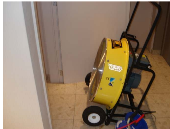
Fig 9.12 & fig 9.13 Lors des essais menés à Oostkamp, deux ventilateurs ont été positionnés en V au niveau de la porte d'entrée d'un immeuble à appartements. Ce dispositif est complété par un troisième ventilateur placé au pied de la cage d'escaliers (Photos: Karel Lambert).
