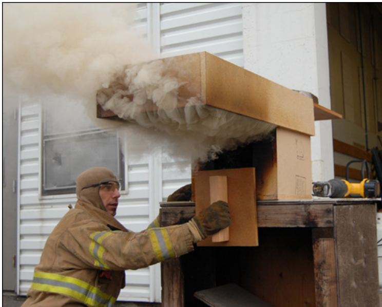
Fig 1.1 Le volume situé à l'arrière est en feu. Les gaz de combustion se sont échappés par les interstices de la porte fermée et forment un mélange explosif au plafond. (Photo: Ed Hartin)
