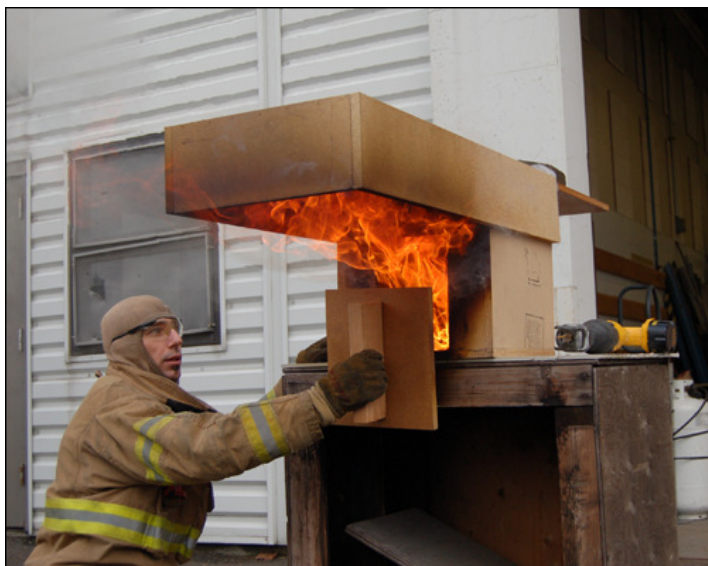
Fig 1.3 Feu pleinement développé après survenue d'un flashfire. (Photo: Ed Hartin)
