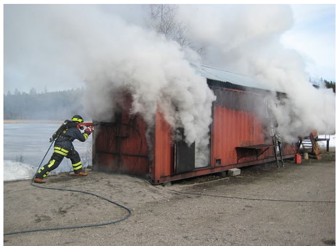
Fig 12.4 Le COBRA en action sur un terrain d'entraînement. Les gaz de l'incendie sont rendu complètement inertes et sont refroidis. (Image: Willem Nater)
